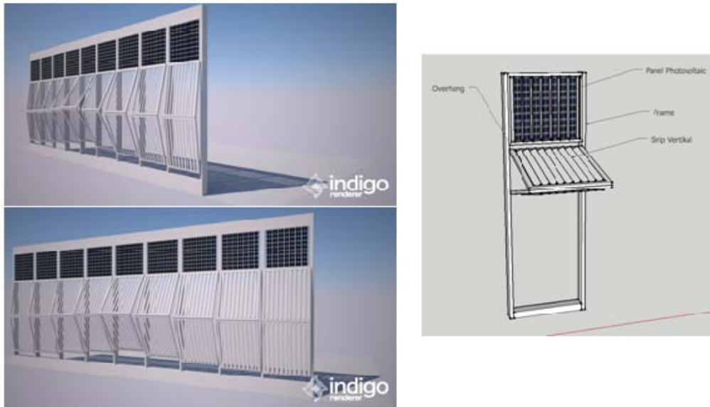
Gambar 10. Contoh alternatif pengembangan rancangan sistem teritisan kinetik.
