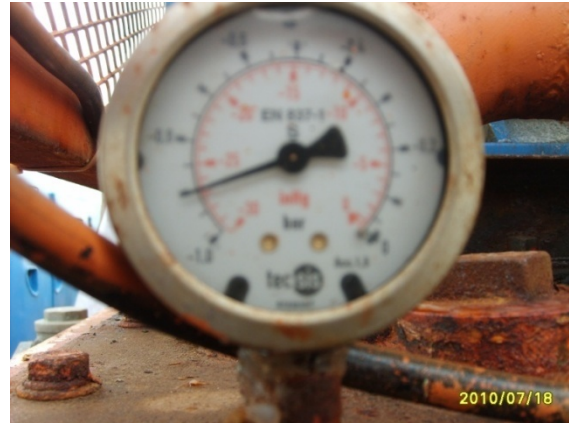
Gambar 13. Bacaan Manometer menunjukkan tegangan vakum mencapai 90 kPa.
