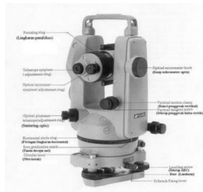
Gambar 2. Teodolit digital dan manual.
